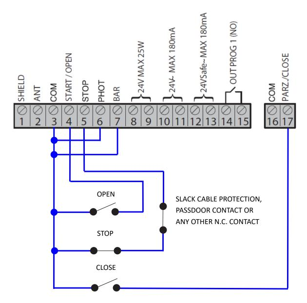
ENG - Connection schema of 3-button panel with ARGO FRA - Schéma de raccordement du triple bouton DEU - Anschlussschema für Drei-Taste NED - Schakelschema van de driedubbele knop FRA - Schemat podłączenia panelu 3-przyciskowego RUS - Схема подключения трёх- кнопки CZE - Schéma zapojení troj-tlačítka
